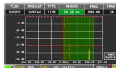
Измер. эхо сигн. в SFN сетях, с импульсным откликом в реж. реальн. врем., зеленое поле - защитн. интерв.
