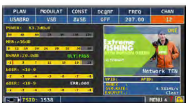
Сигнал VSB, все измер., изображение и настройки на одном экране
